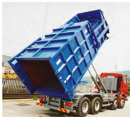
Compactador com basculador de contentores em posição de descarga
