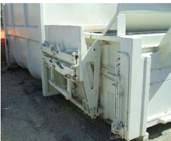
Basculador de contentores para contentores DIN e Oschener para funcionamento com o compactador no chão ou em cima do camião
