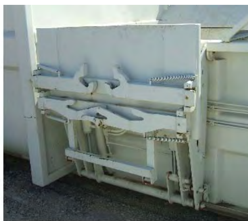
Basculador de contentores para contentores DIN e Oschener para funcionamento com o compactador no chão ou em cima do camião
