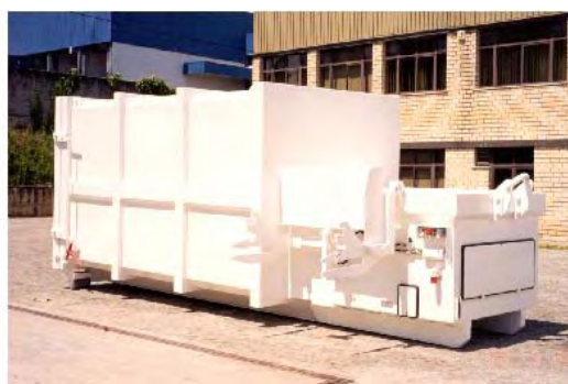
Basculador frontal e lateral para trabalhar com o compactador no chão
