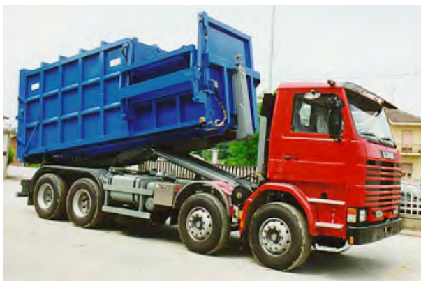
Compactador com basculador de contentores em posição de descarga
